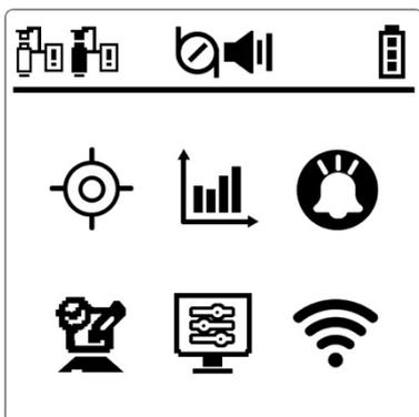
메인 화면에서 위쪽 키와 아래쪽 키를 동시에 누르면 왼쪽에 보이는 설정 화면이 나타납니다. 선택된 아이콘은 테두리가 강조됩니다. 위쪽 키 또는 아래쪽 키를 사용하여 원하는 항목으로 이동한 다음 Enter 키를 눌러 선택합니다. 보정 → 측정 → 알람 → 로그 → 모니터 → 무선 설정 순으로 설정을 할 수 있습니다.
