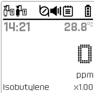
기기가 안정화된 후 정상 측정 모드로 전환되면 LCD 화면에 가스 농도와 배터리 전력 수준이 표시됩니다. 가스 농도는 ppm(혹은 ppb) 단위로 표시되며, 농도 수준이 변하면 실시간으로 값이 업데이트됩니다.
