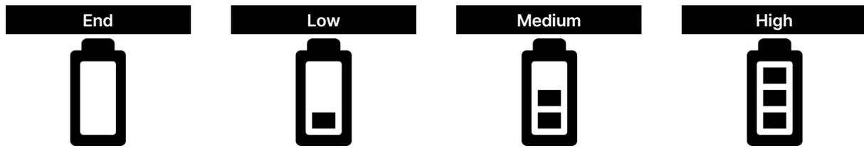
장비를 충전하려면 제공된 충전 어댑터를 장비에 연결한 후 AC 콘센트에 연결합니다. 장비는 배터리가 완전히 충전될 때까지 충전 중임을 나타내는 아이콘이 순환하여 표시되며, 충전기 제거 시 배터리 아이콘은 현재의 배터리 상태를 표시합니다.
